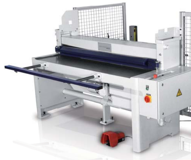
Standard: MHSU mit Rückraumabsicherung über 3-strahlige Lichtschranke incl. seitlichem Schutzgitter
