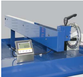
Manueller Hinteranschlag, von vorne verstellbar, mit Digitalanzeige
