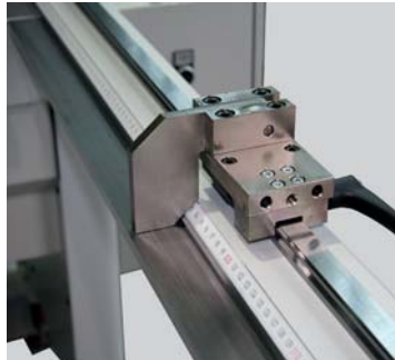
Rechter verlängerter Winkelanschlag mit Maßstab incl. seitlichem Klappanschlag auf Linearführung
