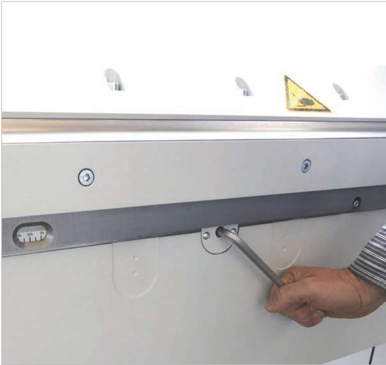
Bombiereinrichtung für die Biegewange: manuelle Zentralbombierung (nicht in Kombination mit gekröpften Biegeschienen)
