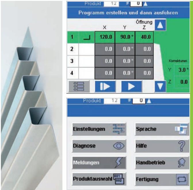
Einfache Symbole und alphanumerische Angaben beschreiben das Biegeprogramm.
