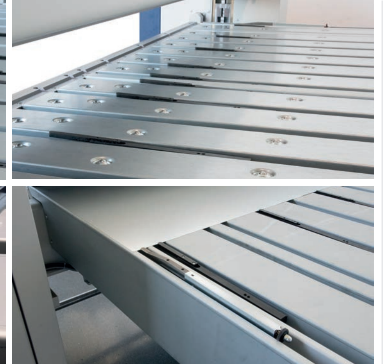
Bild oben: Auflagetisch mit Kugeln Bild unten: verstellbare Anschlagfinger zum konisch Biegen
