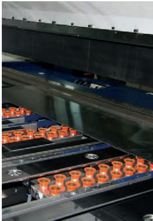
Mit der Option des Saugplattenanschlags können alle Büge an einer Seite mit nur einem Bedieneingriff durchgeführt werden.
