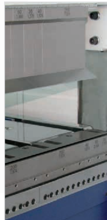
Die motorisch absenk- bare Biegewange und die Biegemittelpunktverstellung sind im Standard enthalten.
