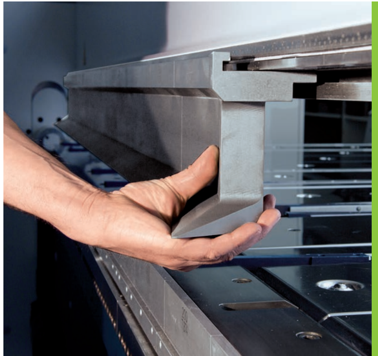
Die hydraulische Werkzeugklemmung an der Oberwange verkürzt Rüstzeiten.
