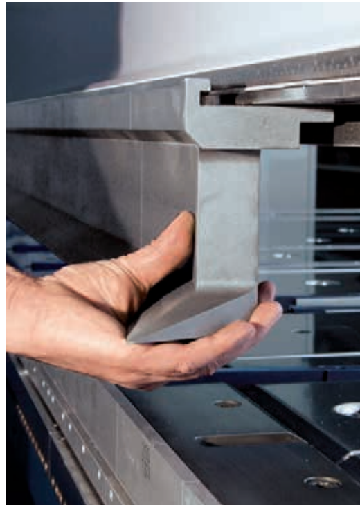
Die hydraulische Werkzeugklemmung an der Oberwange verkürzt Rüstzeiten
