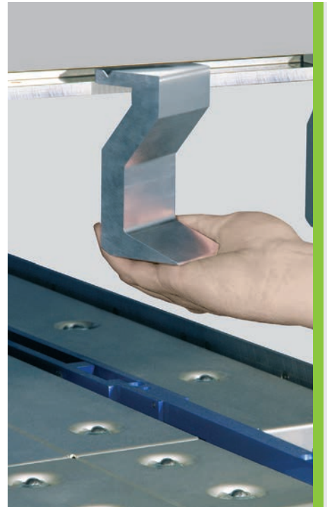
Auf Tastendruck wird die hydraulische Werkzeugklemmung für den schnellen und präzisen Werkzeugwechsel geöffnet.
