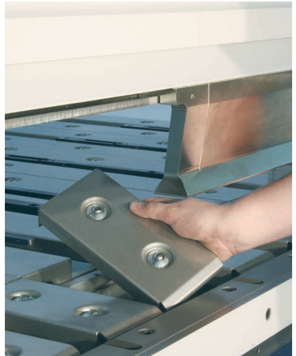
Die herausnehmbaren Kassetten schaffen Raum für Gegenkanten.
