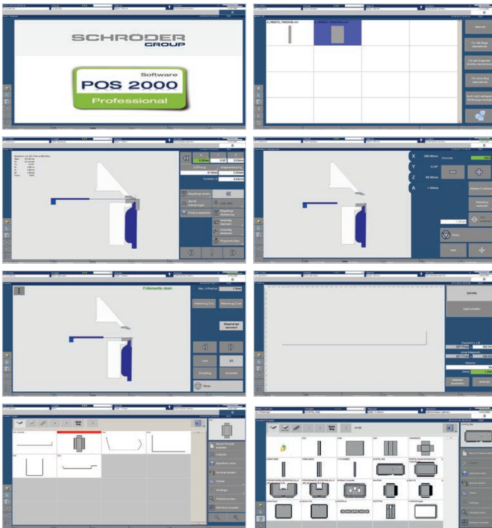
Grafiksteuerung POS 2000 Professional: das Ergebnis immer vor Augen – von den ersten Schritten bis zur Simulation
