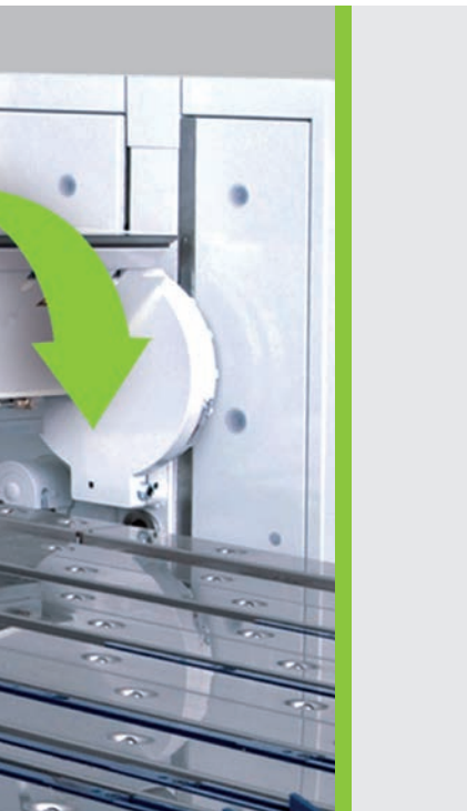
In der drehbaren Oberwange hält die MPB ein zweites Set Werkzeuge parat.
