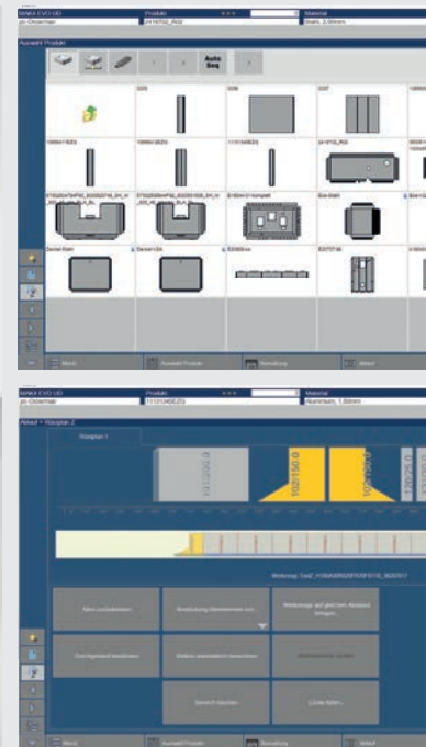
Oben: Die Steuerungssoftware wird zum komfortablen Produktkatalog. Unten: Nicht nur das Werkstück wird dargestellt, sondern auch die Werkzeuge – hier im Rüstplan.
