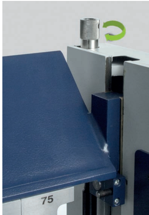
Klemmdruckeinstellung der Oberwange
