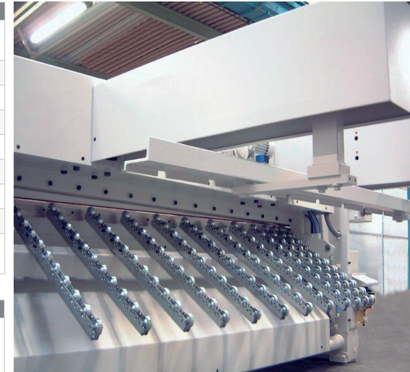
Blechhochhaltevorrichtung pneumatisch gesteuert mit Rollenleisten
